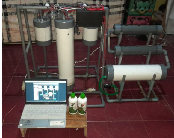
Gambar 1. Implementasi Sistem Pencampuran Nutrisi Hidroponik Berbasis ESP32
